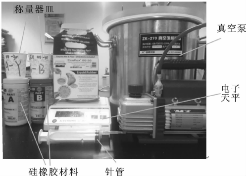
图 3 制作硅胶模型的主要材料和设备
